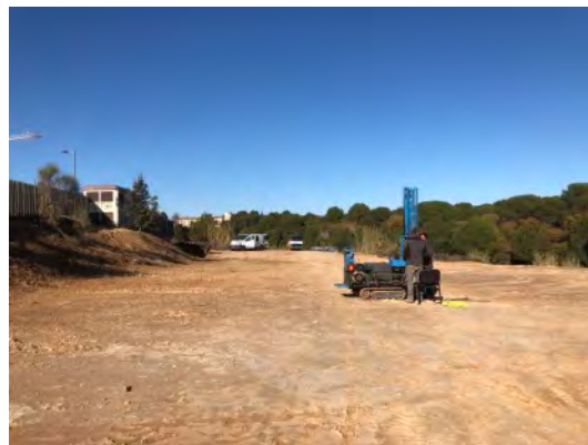
Fot. 4. Penetròmetre dinàmic P1
