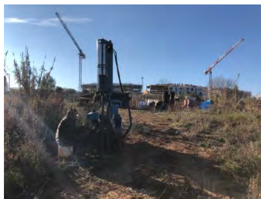
Fot. 5. Penetròmetre dinàmic al punt P-4
